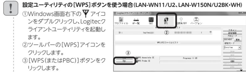
**8** 自動的に以下の画面に変わります。本製品の底面(縦置時)にあるWPSボタンを、1秒~3秒押して作動状態(WPSランプが赤色に点滅)になったら離します。
