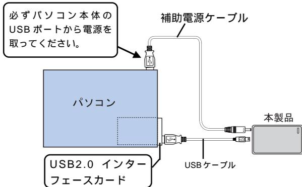
補助電源ケーブルの DC プラグはバスパワー対応機器(本製品)側に接続してください。
