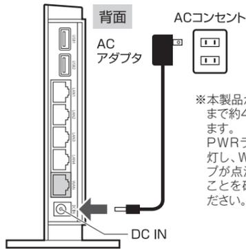
※本製品が起動するまで約40秒かかります。PWRランプが点灯し、WLANランプが点滅していることを確認してください。
