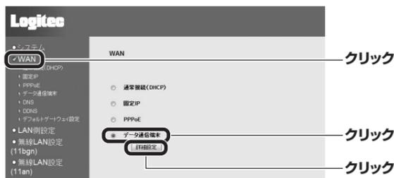
6 お使いのUSBデータ通信カードの契約内容を確認し、ユーザ名、パスワード、APN、ダイヤルスクリプトを入力します。キャリアのリストから選択することで、各キャリアの基本設定が表示されます。接続方式を選択し、「適用」をクリックします。
