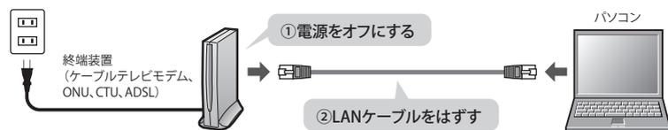
① すでにご使用の終端装置（ケーブルテレビモデム、ONU、CTU、ADSL）のいずれかがある場合、パソコンと接続したLANケーブルをはずします。
