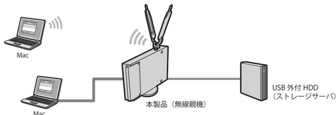
• このように本製品のUSBポートに接続したHDDなどを「ストレージサーバ」と呼びます。
