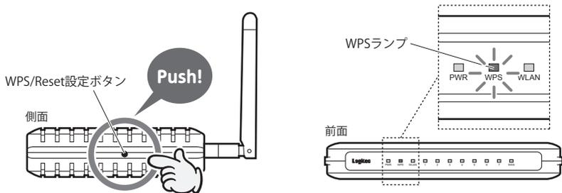
• 前面にあるWPSランプが赤色に点滅し、WPS対応の無線子機の接続を待つ状態になります。WPSランプの点滅中に接続を完了する必要があります。
