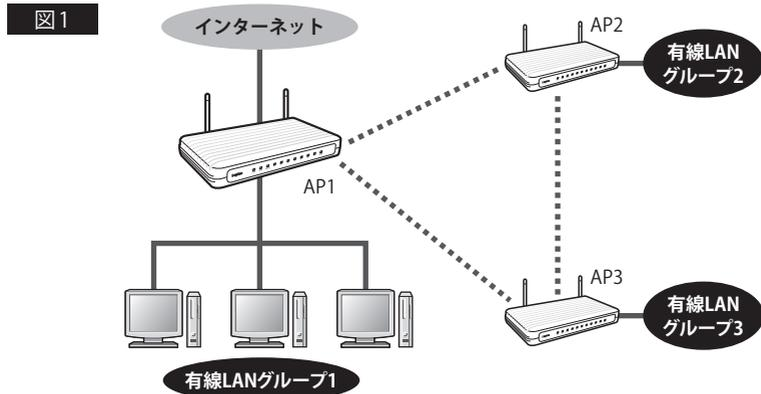
図1のようにAP1～AP3は、お互いが電波の届く範囲にあれば、それぞれの無線AP同士が直接通信することができます。また、図2のようにAP1とAP3が直接通信できない距離にある場合でも、AP1とAP3がそれぞれAP2と通信できる距離にあれば、AP1とAP3は、AP2を中継して通信できます。
