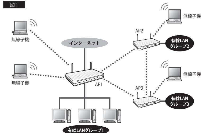
図1のようにAP1～AP3は、お互いが電波の届く範囲にあれば、それぞれのAP同士が直接通信することができます。さらに無線APは、有線クライアントだけでなく、無線子機とも無線LANで接続することができます。また、図2のようにAP1とAP3が直接通信できる距離にない場合でも、AP1とAP3がそれぞれAP2と通信できる距離にあれば、AP1とAP3は、AP2を中継して通信することができます。
