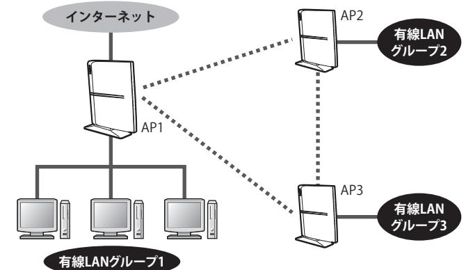
図1のようにAP1～AP3は、お互いが電波の届く範囲にあれば、それぞれの無線AP同士が直接通信することができます。また、図2のようにAP1とAP3が直接通信できない距離にある場合でも、AP1とAP3がそれぞれAP2と通信できる距離にあれば、AP1とAP3は、AP2を中継して通信できます。
