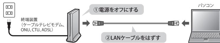
① すでにご使用の終端装置（ケーブルテレビモデム、ONU、CTU、ADSL）のいずれかがある場合、パソコンと接続したLANケーブルをはずします。
