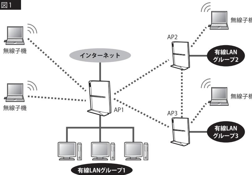
図1のようにAP1～AP3は、お互いが電波の届く範囲にあれば、それぞれのAP同士が直接通信することができます。さらに無線APは、有線クライアントだけでなく、無線子機とも無線LANで接続することができます。また、図2のようにAP1とAP3が直接通信できる距離にない場合でも、AP1とAP3がそれぞれAP2と通信できる距離にあれば、AP1とAP3は、AP2を中継して通信することができます。
