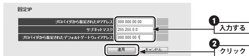
・プロバイダから指定されたIPアドレス、サブネットマスク、デフォルトゲートウェイを入力します。
