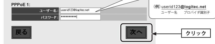
4b P25「設定に必要なプロバイダ情報を用意する」でメモした内容をもとに必要な情報を入力し、[次へ]をクリックします。
