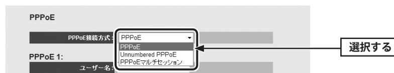
**3 プロバイダから指定されたユーザー名やパスワードなど必要な情報の入力と、オプションなどを設定します。設定が終われば「適用」をクリックします。**
