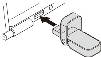
製品のUSBコネクターの向きと、USBポートの上下方向に注意して接続してください。
