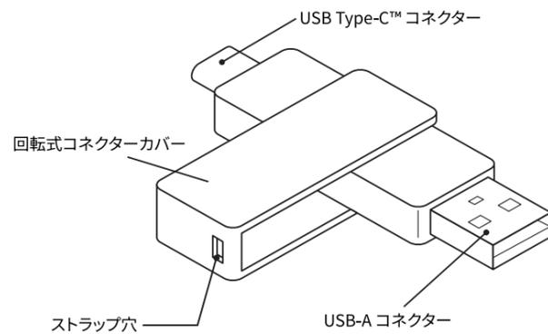
接続するUSBポートに合わせてコネクタカバーを回転させてご使用ください。
