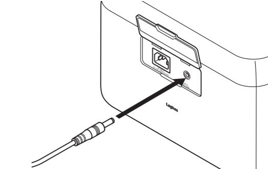
※ロジテック製のポータブル電源と接続する場合は付属の XT60 - DC7909 丸 PIN ケーブルをご使用ください。
