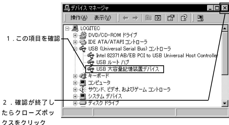
デバイスが登録されていたら、本製品と接続先の SCSI 機器の認識はうまくいっています。次に本製品と SCSI 機器の取り外しについて説明いたしますので、「2.3 本製品を取り外す場合は」へお進みください。
