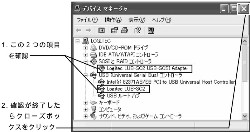
デバイスが登録されていたら、本製品と接続先の SCSI 機器の認識はうまくいっています。次に本製品と SCSI 機器の取り外しについて説明いたしますので、「3.3 本製品を取り外す場合は」へお進みください。
