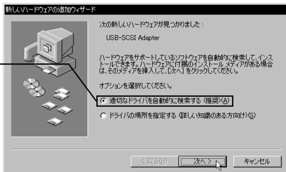
本製品付属の「LogitechWare」CD-ROM を CD-ROM ドライブ にセットすると、自動的にドライバの検索が開始されます。
